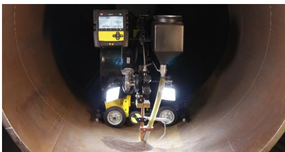
Versotrac con tres ruedas dentro de una tubería y con kit de lámpara LED opcional
