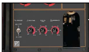
Funciones de temporizador Agrega el bloqueo de gatillo de 4 pasos, modo de punteo, velocidad de inicio ajustable para inicio mas suave del arco y tiempo de quemado en retroceso ajustable para minimizar el pegado del alambre en el charco de soldadura.
