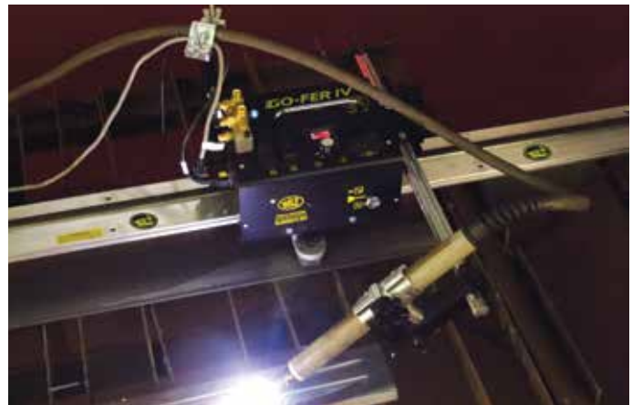
Arriba, configuración de plasma para realizar el ranurado
