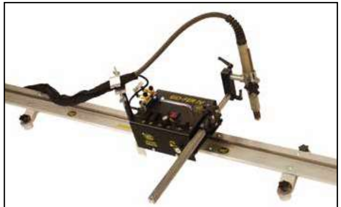
Arriba, configuración de corte por plasma de GO-FER IV
