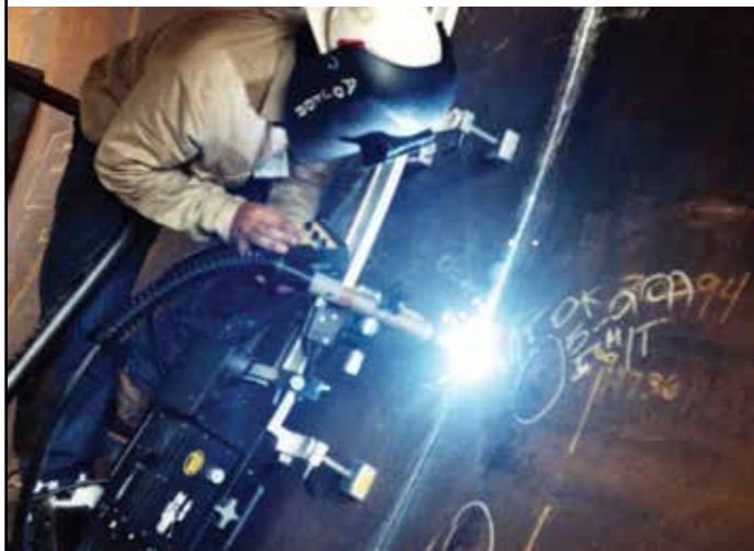
Se muestra arriba - Soldadura con vertical oscilación lineal con barra de soporte ARM-2480 con imanes
